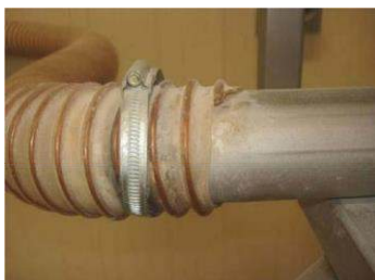
Flexibele koppeling niet geaard
