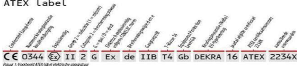
Figuur 1: Voorbeeld ATEX-label elektrische apparatuur
