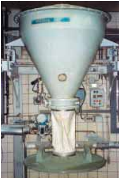
Voorbeeld van geautomatiseerde 'op maat' verplaatsing van meel en vloeibare grondstoffen via de deksel van een mengkuip.
